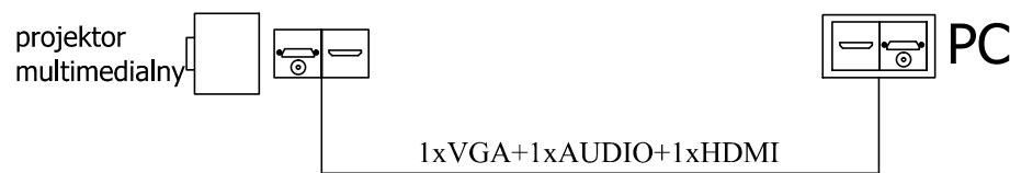
schemat podłączenia projektora multimedialnego (sala konferencyjna)
